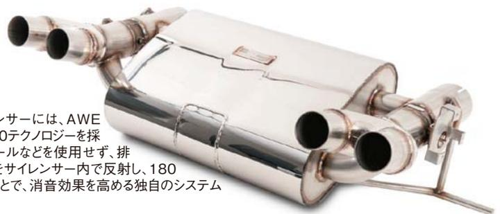
メインサイレンサーには、AWE TUNING 180テクノロジーを採用。グラスウールなどを使用せず、排気音の音波をサイレンサー内で反射し、180度位相することで、消音効果を高める独自のシステムです。
