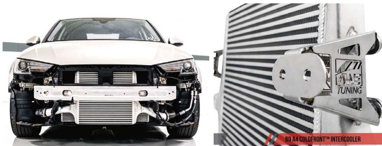
インタークーラーといえば、ターボチャージャー搭載車に純正から装着されているパーツです。ターボチャージャーとは、エンジンに強制的に空気を送り込むため、より圧縮した空気を入れて、エンジンのパワーを高めるシステムです。
